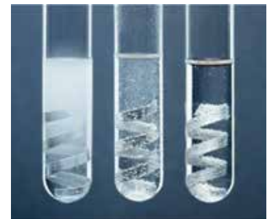
الشكل (3): تفاعل فلز المغنيسيوم مع حمض \text{HCl} .
